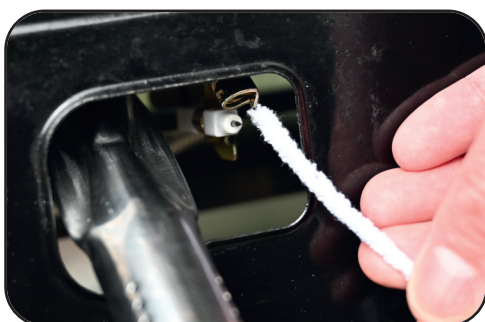
Reinigung des Pilotbrenners mit Hilfe eines Chenilledrahts oder Pfeifenreinigers.
